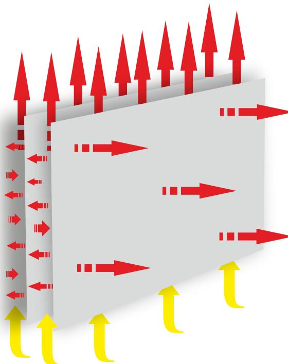
Любой обогреватель при нагреве тянет на себя холодный воздух. Холодный воздух, проходя через воздушные камеры, прогревается до 50° и, со скоростью 3-6 метров в секунду, свободно поднимается наверх, одновременно нагревая стену и перемешивая воздух.
